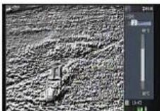
Durante il volo di test con un drone, la FLIR G300a ha rilevato con estrema precisione la fuoriuscita di gas da una bombola collocata a terra (in alto: modalità termica, in basso: modalità VISN).
