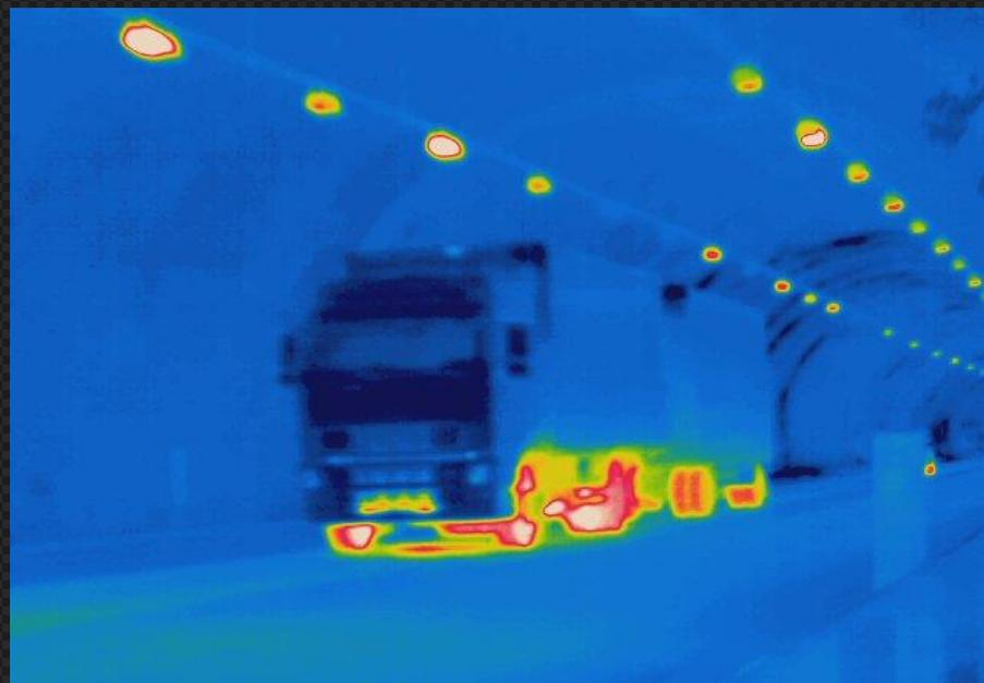
Con il sistema termografico è possibile monitorare gallerie stradali e ferroviarie, per individuazione veicoli, autocarri, treni con temperature eccessive, e conseguente pericolo d'incendio.
