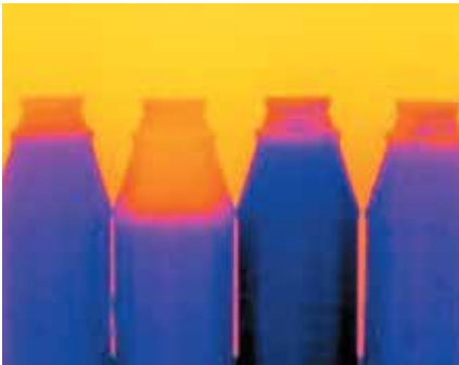
Rilevazione dei livelli del liquido nelle bottiglie di vetro opaco.
