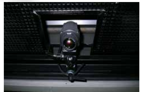
Una soluzione centrale: TOPA ha installato termocamere FLIR A310 con obiettivi grandangolari da 45° su ciascuno dei 10 dinamometri.
