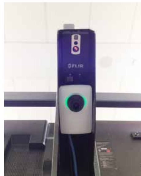
Quando un oggetto con temperatura superiore a una soglia predefinita passa sotto la termocamera, l'immagine inquadrata viene registrata. Successivamente, un sistema di rilevamento di forme analizza l'immagine salvata.
