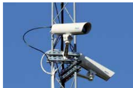
L'alta risoluzione della FLIR A615 si traduce in un vantaggio economico per Termisk, perché consente di ridurre il numero di termocamere necessarie ad analizzare l'intera area.
